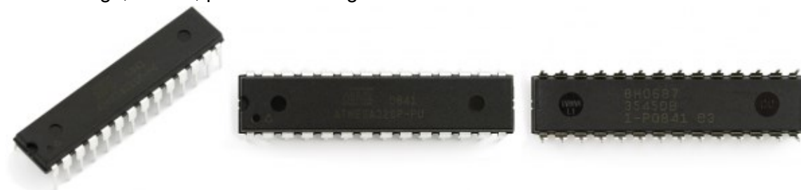
De 28-pins ATmega328 is een van de populairdere DIP-verpakte microcontrollers.
